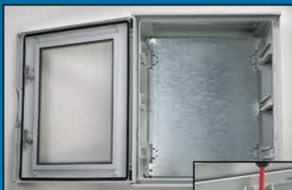
Pozinkovanou montážní desku lze ukotvit pomocí posuvných zámků a zajistit pomocí šroubováku.
